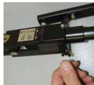
Instale o acessório do parafuso, assegurando - se de que esteja assentado. Aperte a porca borboleta até ajustá-la.
