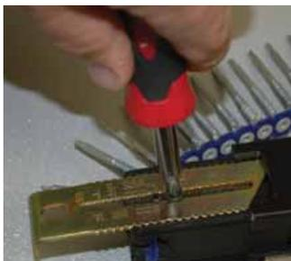
Tire o parafuso com uma chave de fenda Phillips. Alinhe as marcas do cabeçote com a guia mestra para escolher o comprimento adequado do parafuso. Para apertar o parafuso, baixe o cabeçote aplicando uma leve pressão. Aperte o parafuso para garantir que esteja ajustado com a placa deslizante.
