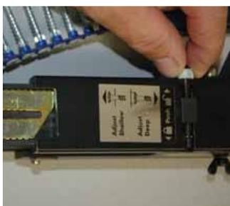
Ajuste a profundidade do parafuso girando o ajuste de profundidade. Consulte o gráfico mostrado na ferramenta para uma operação apropriada.
